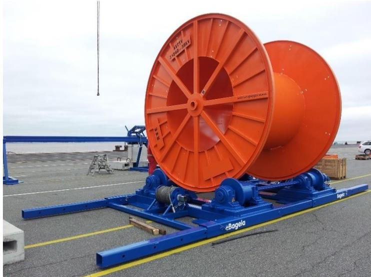
Abbildung 23: Trommelbock (beispielhaft Fa. Bagela)
