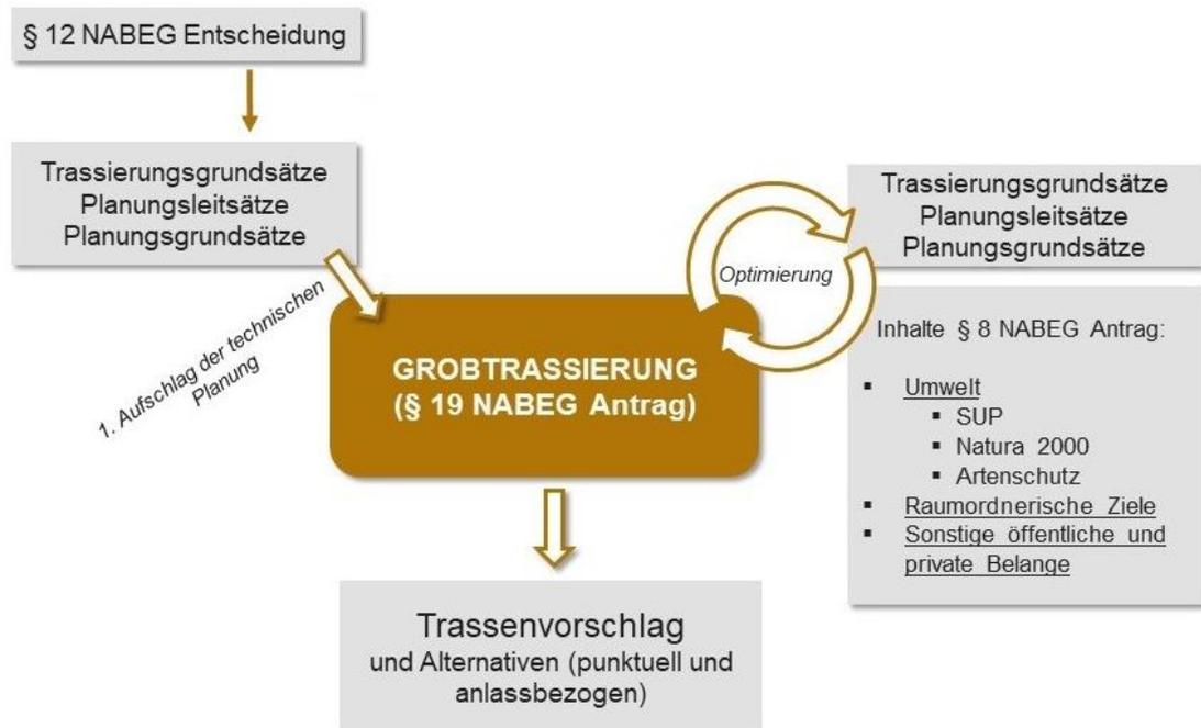
**Abbildung 3: Der iterative Prozess der Grobtrassierung für die Entwicklung des Trassenvorschlags und der in Frage kommenden Alternativen für den Antrag gemäß § 19 NABEG**
