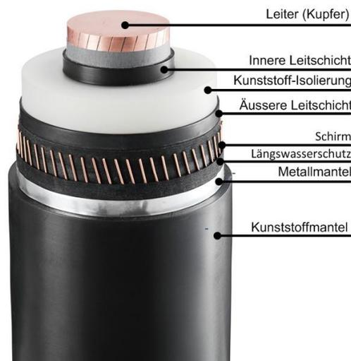
Abbildung 4: Kabelaufbau (beispielhaft) (Quelle: „Broschüre Hochspannungskabel von ABB“)
