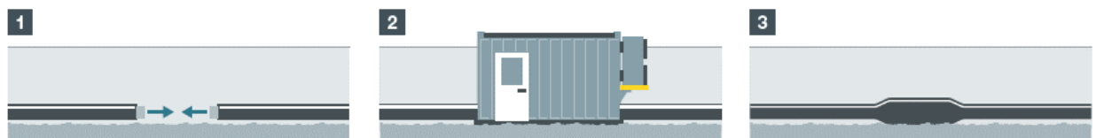
Abbildung 8: Schematische Darstellung der Kabelverbindungen (Muffen)
