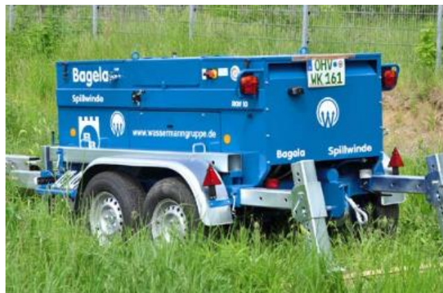
Abbildung 35: Beispiel einer Kabelziehwinde
