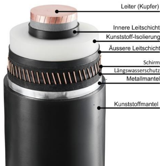
Abbildung 7: Kabelaufbau beispielhaft (Quelle: „Broschüre Hochspannungskabel von ABB“)
